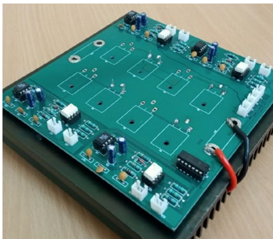
Rys. 3 Rozwój prototypu laboratoryjnego konwertera z wieloma portami (NIT Trichy)
