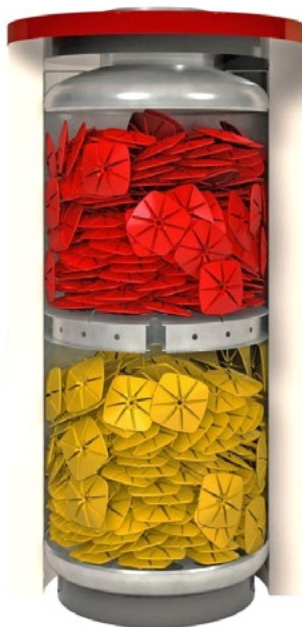
Rys. 3 Magazyn PCM: Średnica/75 cm, wysokość/170 cm, pojemność 500 litrów, 440 elementów PCM, moc/15-20 kWh.
